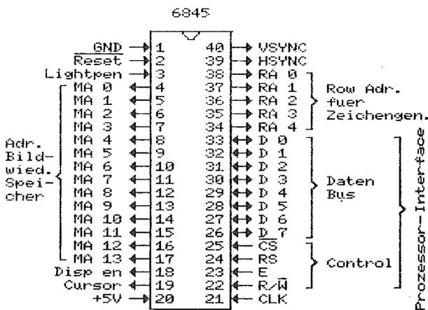
Der 6845 belegt nur zwei I/O-Adressen. Beim SVI-Computer handelt es sich um die Adressen 50H und 51H. Zur Auswahl dient der Eingang RS (register select). Der direkte Zugriff auf das Video-RAM der 80 Zeichen-Karte wird auf der Adresse 58H mit FFH ermöglicht, mit 0 wird das Video-RAM wieder weggeschaltet (CRT Bank Control).
